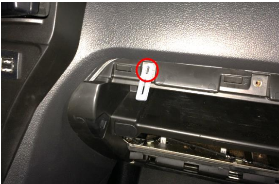
Installation du support de retenue du câble
