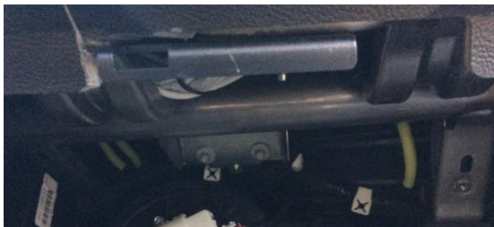
Installation du nouveau loquet
